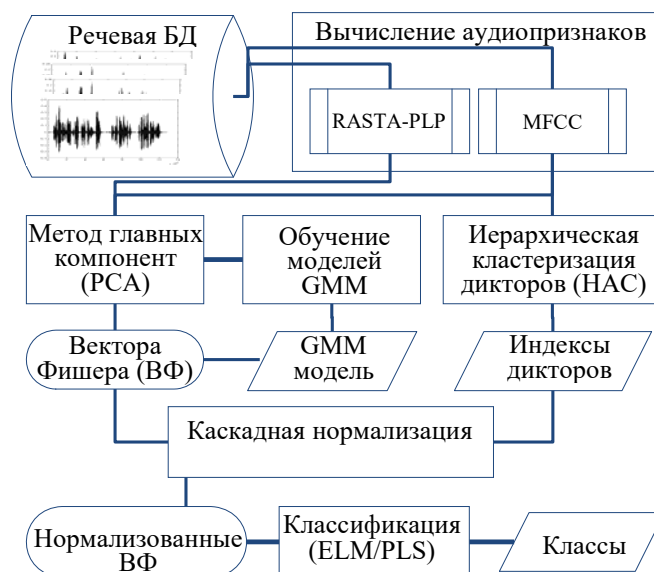
Рис. 2. Архитектура автоматической системы для классификации речевых паралингвистических явлений
