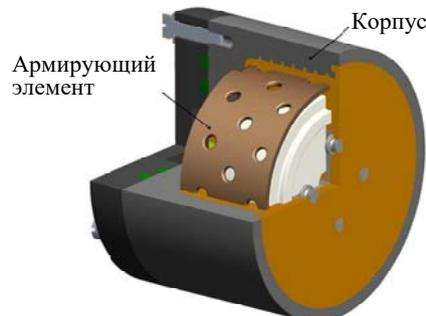
Рис. 7. Армирование датчика
