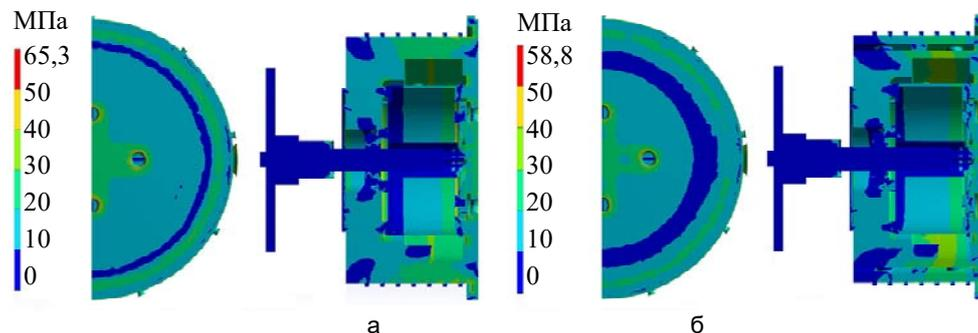
Рис. 8. Влияние армирования компаунда: датчик без армирующего элемента (а); датчик с армирующим элементом (б)
