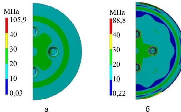
Рис. 6. Влияние корпуса: датчик без корпуса (а); датчик с корпусом (б)
