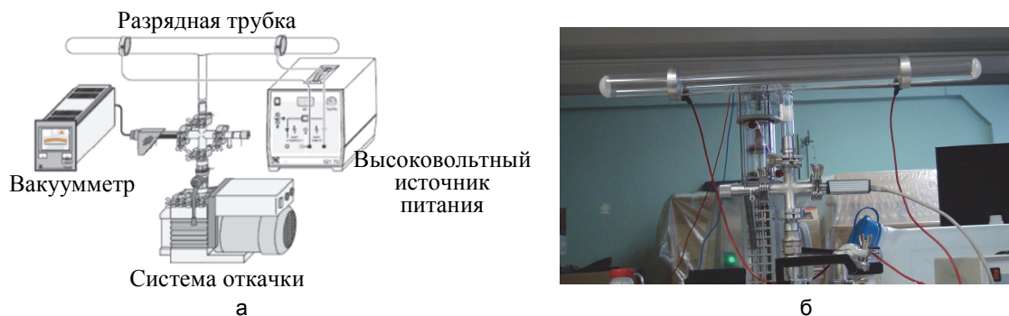
Рис. 1. Экспериментальная установки для изучения газового разряда: схема установки (а); общий вид установки (б)
