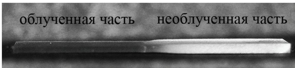
Рис. 4. Фотография торца образца ФТР стекла. Исходная толщина образца  $h=1$  мм. Левая часть образца облучена УФ излучением, правая часть образца не облучена. Температура термообработки  $T=500^\circ\text{C}$ , время термообработки  $t=10$  ч. После травления получена ступенька: толщина правой части образца  $h=0,85$  мм и толщина левой части образца  $h=0,59$  мм
