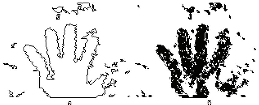
Рис. 1. Выделение движущейся руки на основе двух методов: поиск контуров (а); объединение областей (б)
