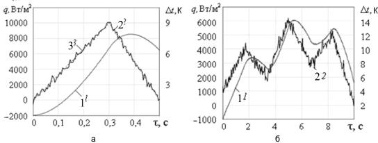
Рис. 1. Результаты имитационного моделирования восстановления теплового потока для батарейного ПТП при различных законах изменения теплового потока: импульсное воздействие (а); переодический закон (б). Обозначения: 1 — измеренная разность температуры; 2 — восстановленный тепловой поток; 3 — истинный тепловой поток
