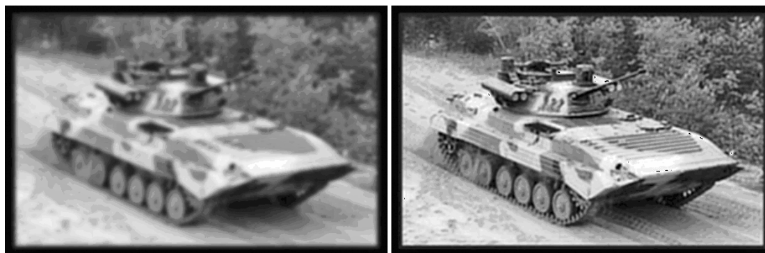
а б Рис. 1. Дефокусированное и зашумленное изображение с размытием краев (а); изображение, восстановленное методом итеративной регуляризации Фридмана ( \nu = 1/\|A\| , число итераций k^* = 200 ) (б)
