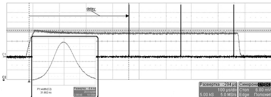
Рис. 2. Осциллограмма импульса генерации Er:YLF-лазера в режиме пассивной модуляции добротности резонатора затвором на кристалле Fe<sup>2+</sup>:ZnSe
