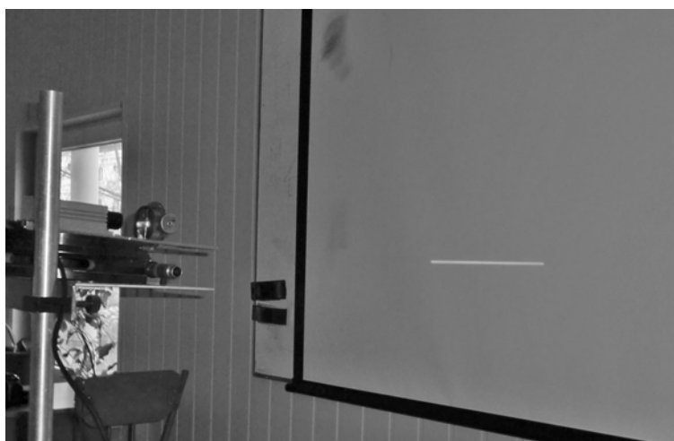
Рис. 8. Фотография генератора линии, сформированной решеткой со сбитым периодом
