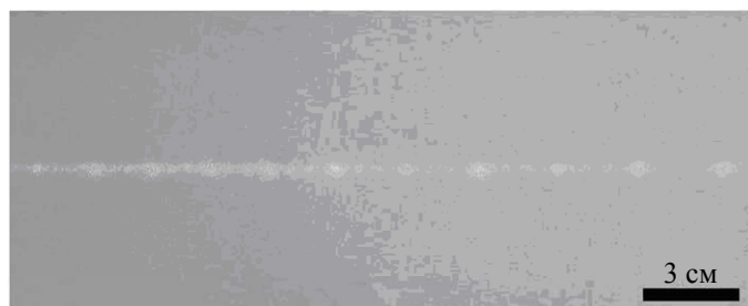
Рис. 5. Фотография линии, сформированной периодической решеткой
