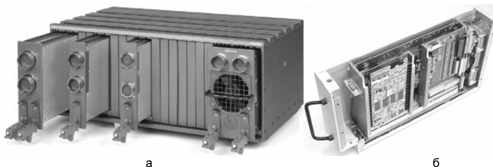
Рис. 2. Крейт модульной авионики разработки Rockwell Collins (а) и модуль IMA разработки National Aerospace Laboratory (Голландия) (б)
