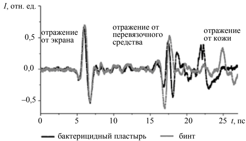
Рис. 4. ТГц сигнал, отраженный от кожи перебинтованной руки человека (серый) и с приклеенным на нее бактерицидным лейкопластырем (черный)
