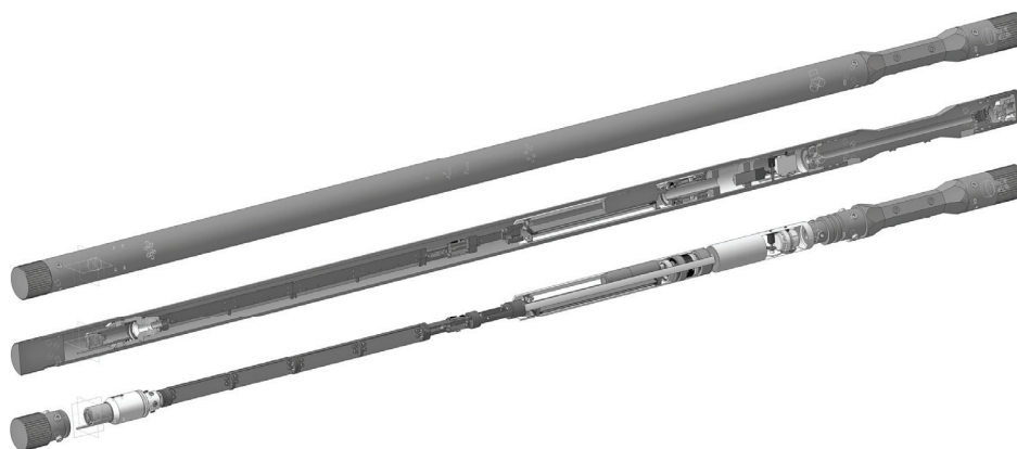
Рис. 2. Трехмерная модель конструктивной компоновки модуля ориентации гироскопической системы подземной навигации
