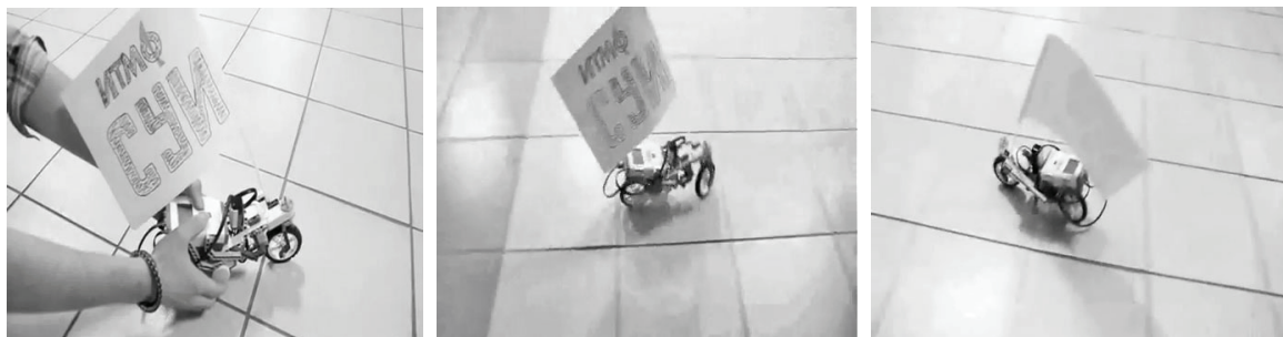
Рис. 4. Движение мобильного робота «Мотобот» с коррекцией траектории
