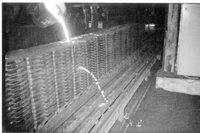
Рис. 1. Завышенное позиционирование ковша с металлом относительно заливочной формы и ее разрушение
