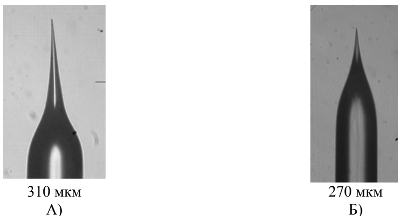
Рис. 7. Зонды, полученные на установке с электромагнитом. А) – без контроля удлинения. Б) – с контролем удлинения на 100 мкм. Мощность лазерного излучения 8 Вт
