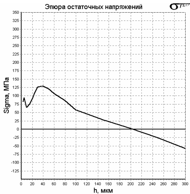
Рис. 7. Релаксация эпюры остаточных напряжений после 397000 циклов нагружения
