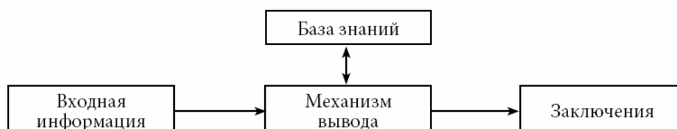
Рис. 1. Взаимодействие блоков экспертной системы
