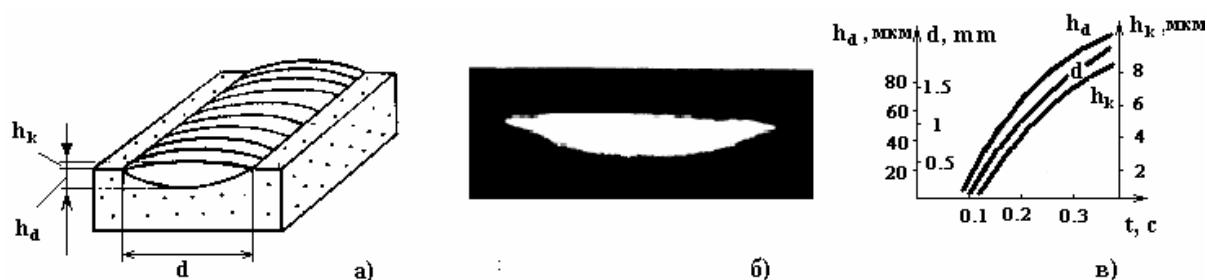
Рис. 4. Общий вид (а), поперечное сечение (б) оптического волновода и кинетика формирования (начальная стадия аморфизации): зависимости высоты ( h_k ), глубины ( h_d ) и ширины ( d ) волновода от времени лазерного воздействия ( d_0 = 1.5 мм, q = 0.5 \cdot 10^6 Вт/м 2 , \tau = d_0/V_{ск} , T_0 \approx 800 К).
