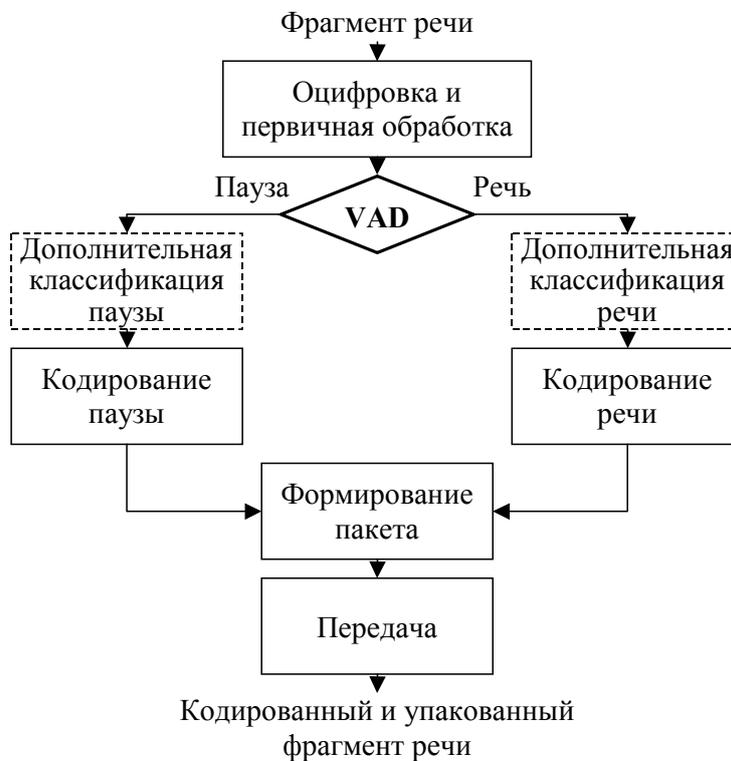
Рис. 1. Общая схема механизма прерывистой передачи при обработке фрагмента речи в передатчике
