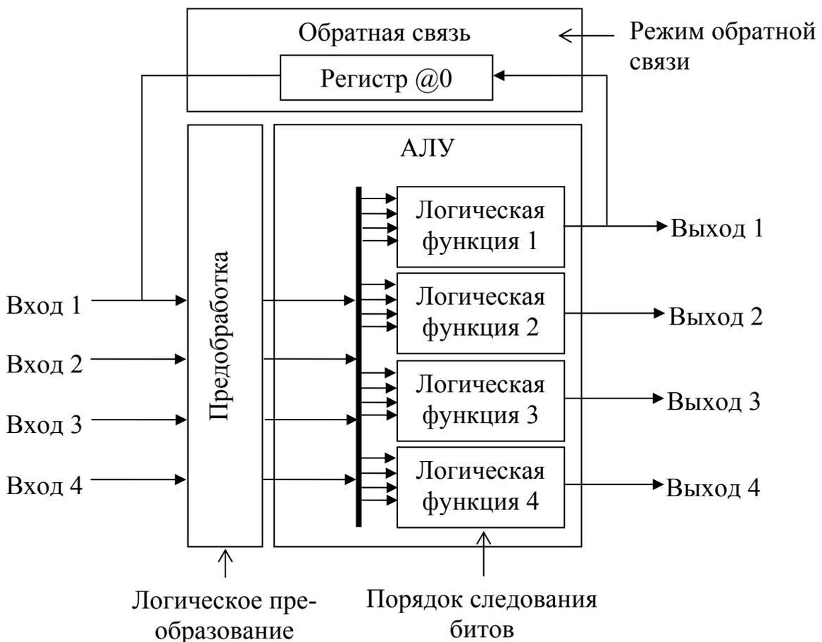
Рис. 3. Структура ядра виртуальной машины NL2.
