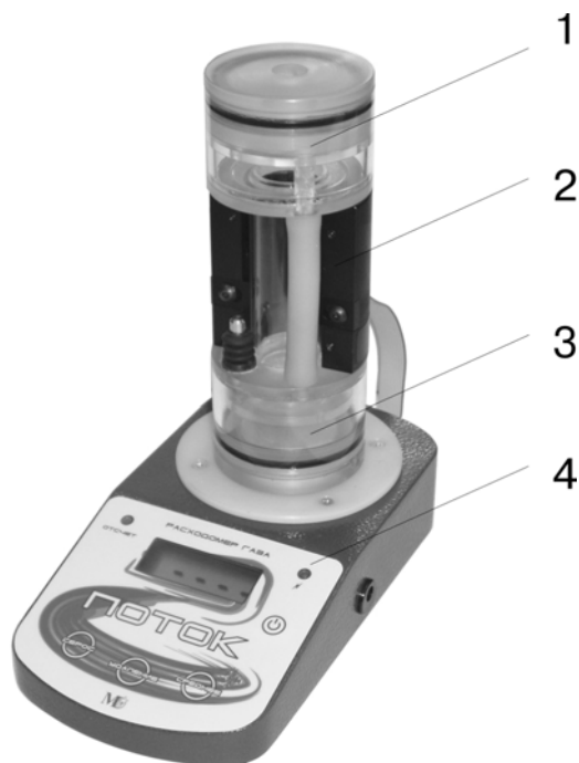
Рис. 1. Внешний вид электронного мыльно-пленочного расходомера: 1 – контрольно-управляющий блок; 2 – сменная ячейка потока в составе генератора пленки; 3 – сенсорный блок; 4 – мыльный раствор
