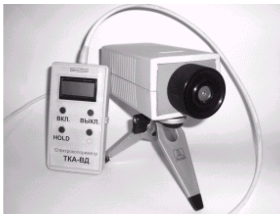
Рис. 2. Спектрофотоколориметр «ТКА – ВД»
