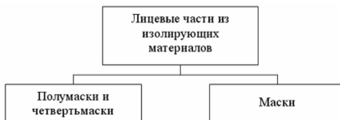
Рис. 2. Классификация лицевых частей из изолирующих материалов
