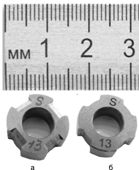
Рис. 3. Сравнительный анализ двух методов нанесения надписей на магните: электрографической гравировкой (а); лазерной маркировкой (б)
