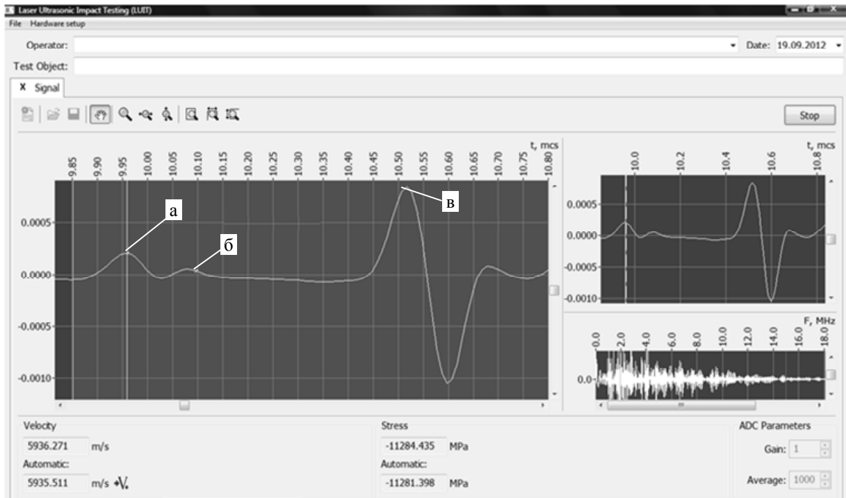
Рис. 3. Окно программы для измерения скорости ультразвуковых волн: а – импульс продольной подповерхностной волны; б – переотраженный импульс продольной подповерхностной волны; в – импульс продольной волны
