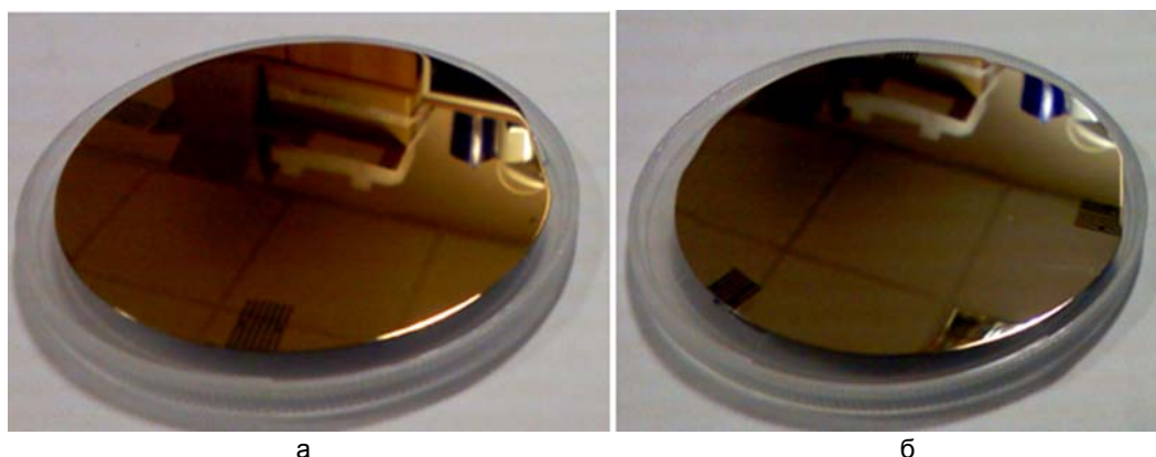
Рис. 2. Кремниевая подложка с металлическими пленками толщиной 50 нм, полученными электронно-лучевым распылением мишени: золото (а); серебро (б). Диаметр образцов 50,8 мм
