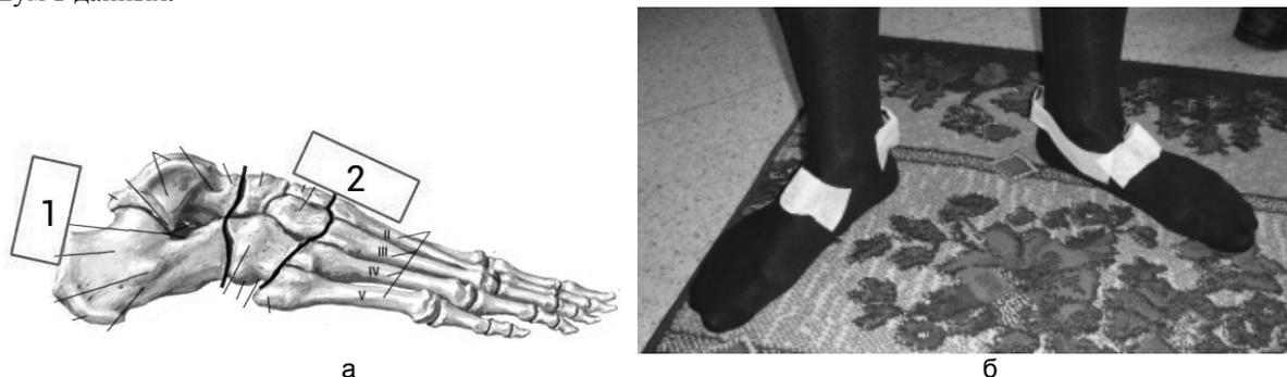
Рис. 1. Схема (а): 1, 2 – измерительные устройства и (б) место установки устройств на человеке
