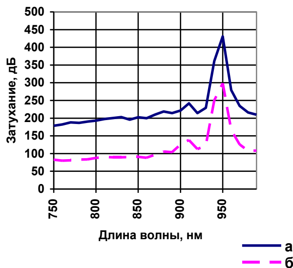
Рис. 4. Спектр затухания излучения в кварц-полимерном волокне из контрольной части сборки (а) и после дополнительной очистки и продувки азотом (б)
