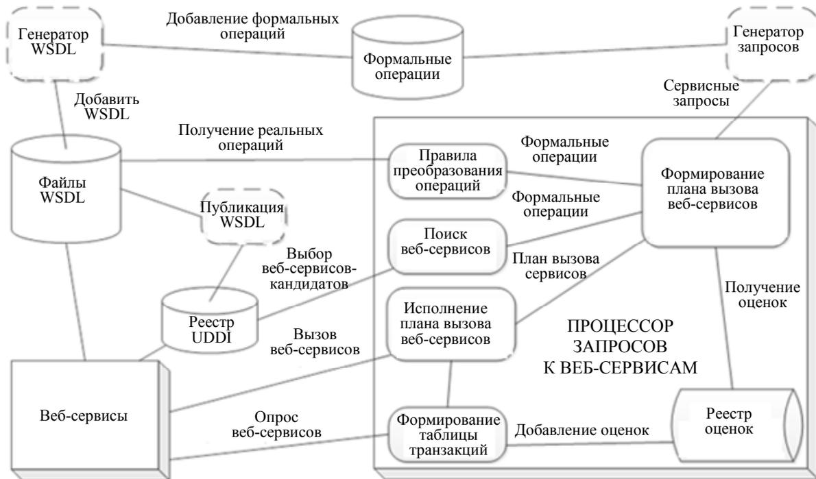
Рисунок. Архитектура системы организации доступа к веб-сервисам
