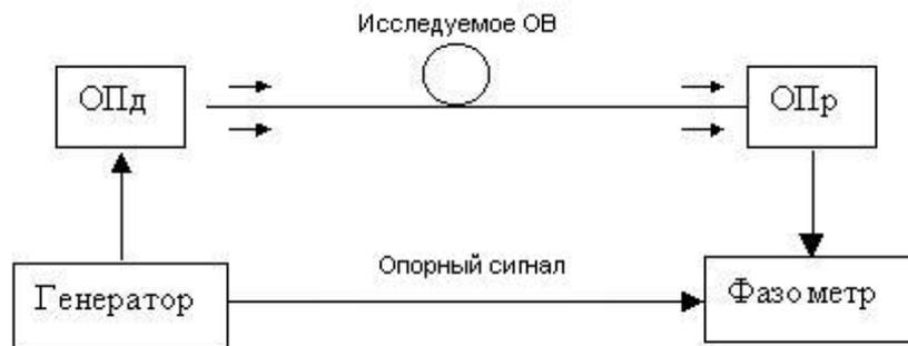
Рис. 4. Простейшая схема метода фазового сдвига
