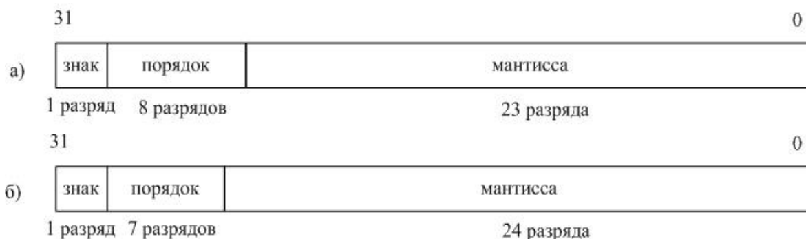
Рис. 1. Формат чисел с плавающей запятой, в котором скрытый бит мантиисы представлен в явном виде
