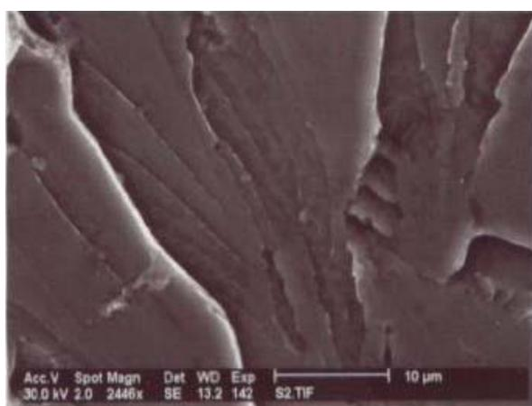
Рис. 2. Вязкое разрушение Ст5
