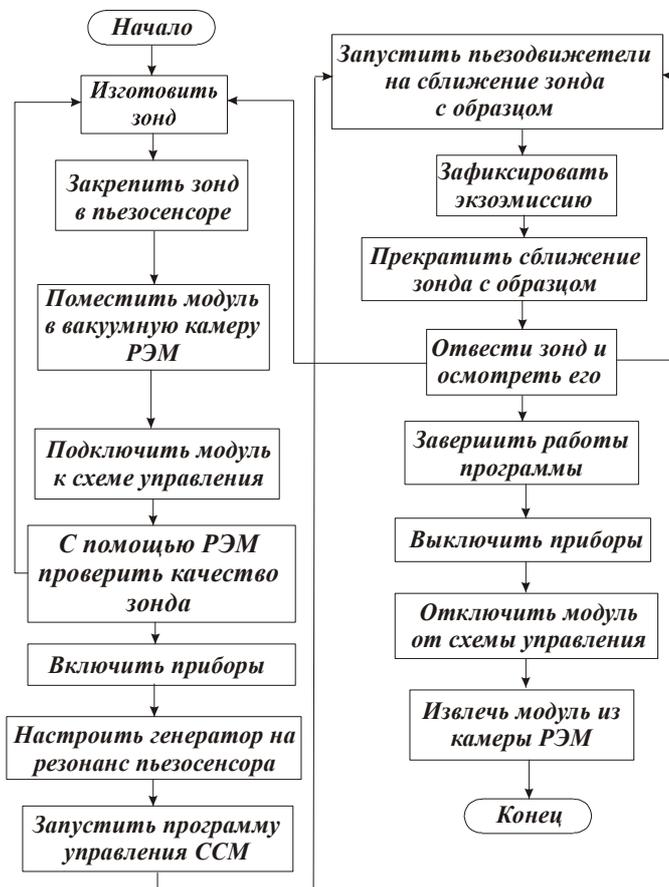
Рис. 7 Алгоритм проведения эксперимента
