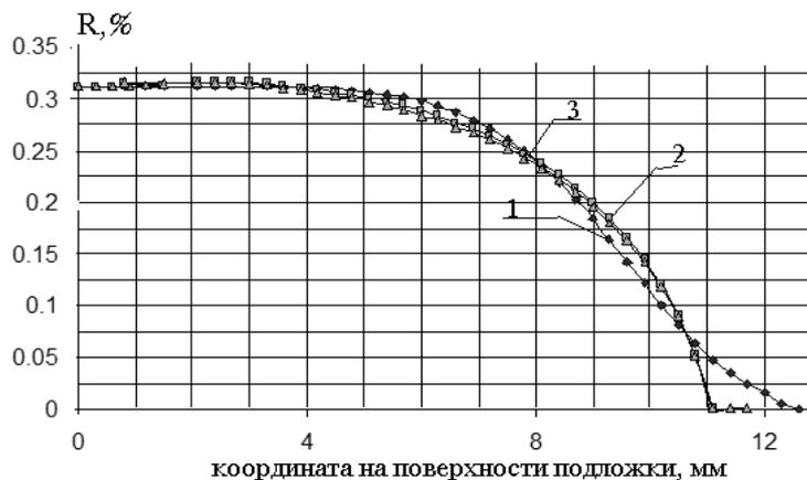
Рис. 3. Кривая 1 – заданное распределение коэффициента отражения, кривая 2 – расчетное распределение при  $f(\rho)=1$ , кривая 3 – расчетное распределение при  $f(\rho)=1+\rho^2$
