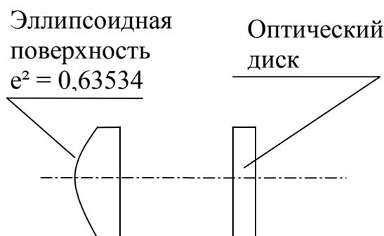
Рис. 2. Асферический однолинзовый объектив  $A = 0,4$ .
