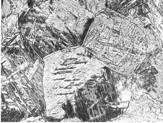
Рис. 10. Микроструктура металла лопатки непосредственно под эродированной поверхностью в плоскости №1 (сплав TC5)
