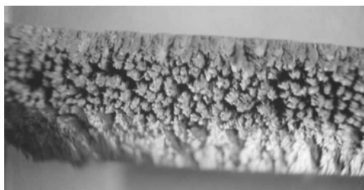
Рис. 5. Внешний вид эродированной поверхности №1 (увеличение 40 х )
