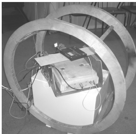
Рис. 12. Установка для изучения влияния внешнего магнитного поля на выходной сигнал ВОГ
