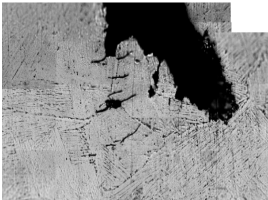
Рис. 12. Микроструктура металла лопатки (сплав TC5) под эродированной поверхностью в плоскости №3
