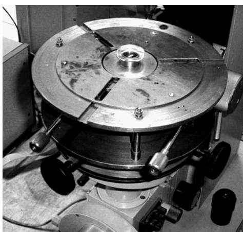
Рис.10. Контроль линзы на интерферометре Физо
