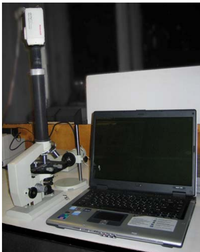
Рис. 3. Макет установки для исследования качества микрообъективов по изображению «точки» ИТМО
