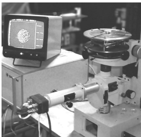
Рис. 9. Общий вид интерферометра Физо в агрегате с анализатором интерферограмм ТАИ-1, при контроле линзы
