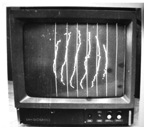
Рис. 21. Генерация управляемой опорной шкалы как модели идеальной интерферограммы
