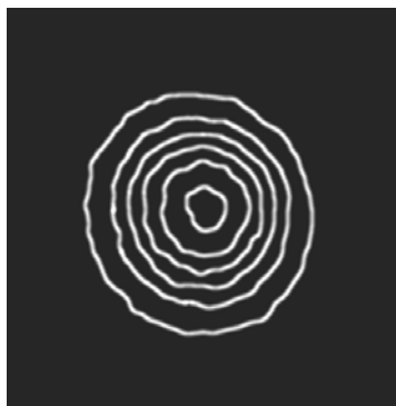
Рис. 9. Изофотограмма экспериментального дифрагированного пятна распределения освещенности в дальнем поле
