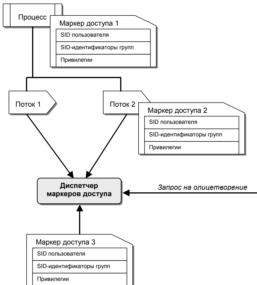
Рис. 2. Внедрение диспетчера маркеров доступа в процесс обработки запросов на олицетворение
