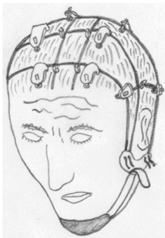
Рис.2,б. Расположение электродов на поверхности головы при регистрации ЭЭГ
