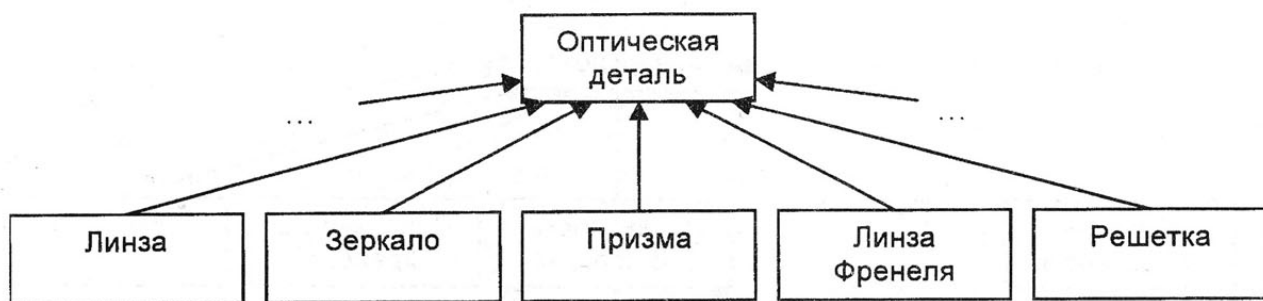
Рис. 4. Диаграмма наследования от элементарного объекта типа "Оптическая деталь"
