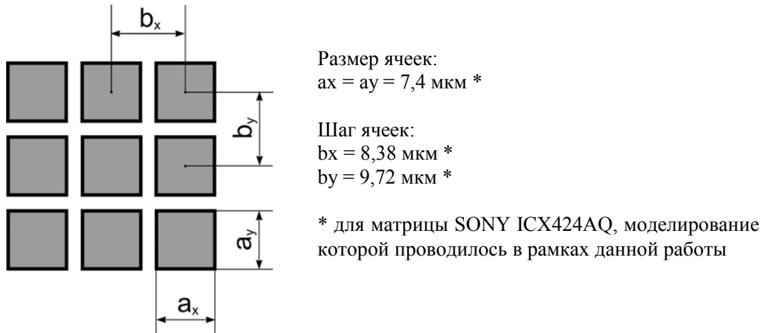
Рис. 2.. Геометрические характеристики ячеек ПЗС-матрицы
