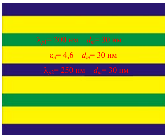
Рис. 2. Структура рассматриваемого металлодиэлектрического метаматериала с элементарной ячейкой, состоящей из двух чередующихся слоев диэлектрика с диэлектрической проницаемостью 4,6 и двух слоев из металлов с разными плазменными длинами волн
