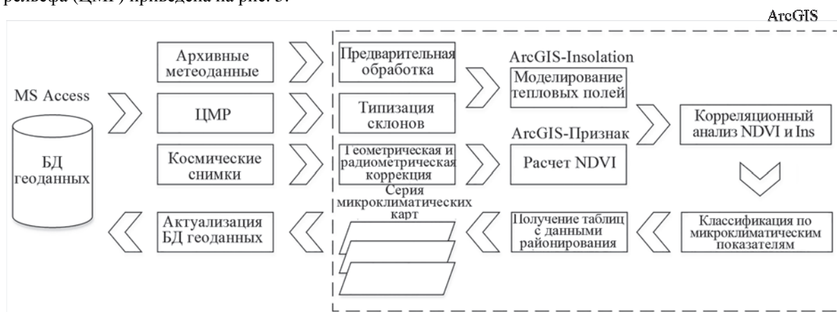
Рис. 5. ГИС-технология составления микроклиматических карт
