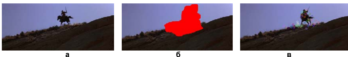
Рис. 1. Исходное изображение (а), поле оптического потока (б) и изображение с выделенными ключевыми точками (в) на основе алгоритма VISWORD
