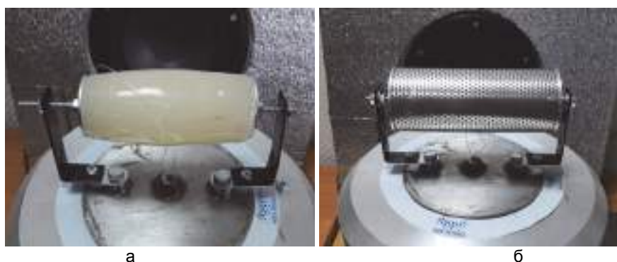
Рис. 4. Чувствительный элемент волоконно-оптического гидрофона: без защитного корпуса (а); в защитном корпусе (б)
