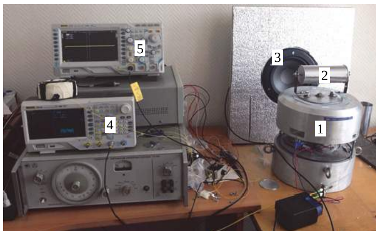
Рис. 3. Экспериментальный стенд для исследования защитного корпуса: 1 – действующий макет донной сейсмической станции, 2 – чувствительный элемент волоконно-оптического гидрофона в защитном корпусе, 3 – динамик, 4 – генератор сигналов, 5 – осциллограф
