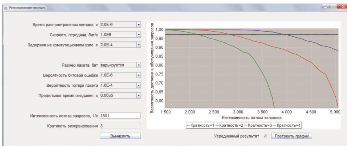
Рис. 5. Графический пользовательский интерфейс разработанного программного средства
