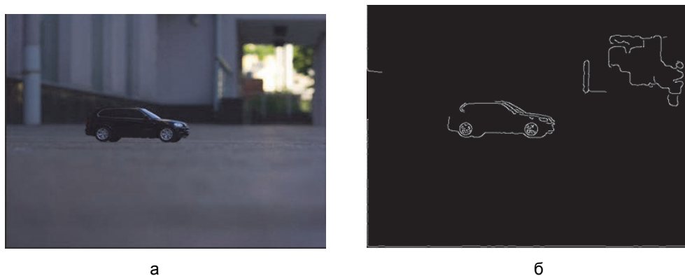
Рис. 1. Исходное изображение (а) и результат детектирования границ методом Канни (б)
