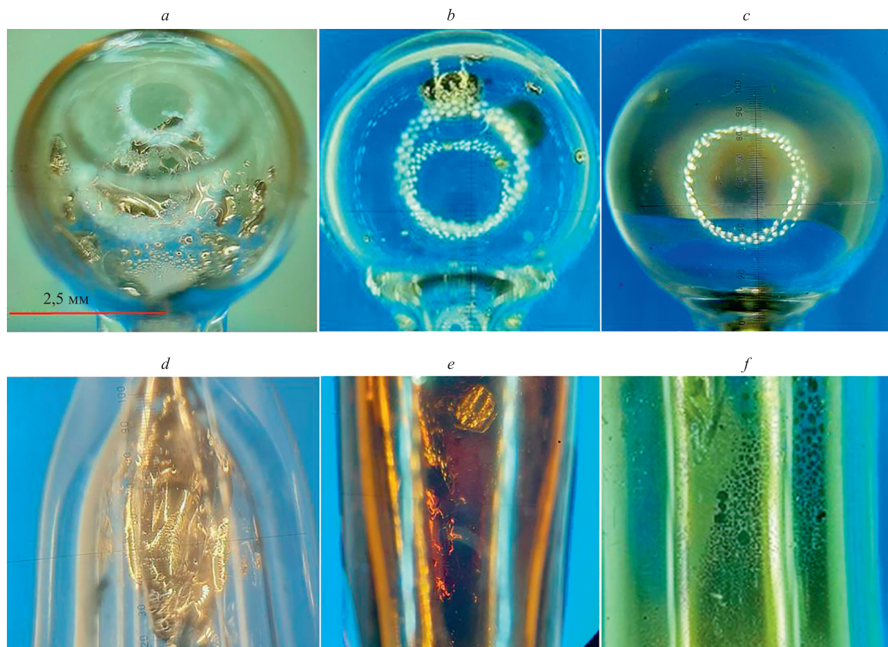
Рис. 5. Сферическая часть ампул: вакуум 7,5 \cdot 10^{-9} торр (a); 50 торр азота (b); 100 торр азота (c). Цилиндрическая часть ампул: вакуум 7,5 \cdot 10^{-9} торр (d); 50 торр азота (e); 100 торр азота (f)
