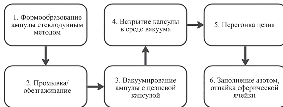
Рис. 7. Технологическая схема изготовления газовой ячейки
