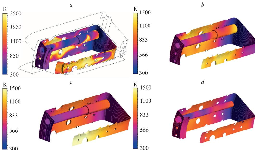
Рис. 2. Распределение температуры на стенках жаровой трубы для моделей: I (a); II (b); III (c); IV (d)
