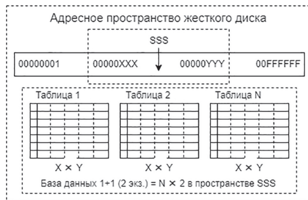
Рис. 2. Графическое представление базы данных SubBase
