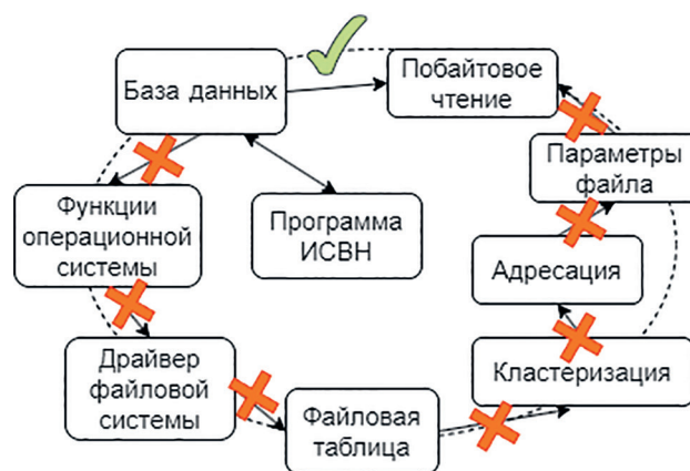
Рис. 3. Схема доступа к данным интеллектуальной системы видеонаблюдения (ИСВН) при использовании разработанной файловой системы
