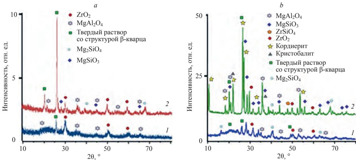
Рис. 1. Рентгенограммы гелей 1 (a) и 2 (b), термообработанных при температурах 900 °С (кривые 1) и 1150 °С (кривые 2)
