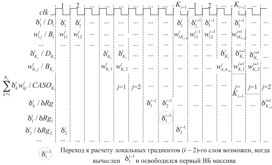
Рис. 5. Временная диаграмма работы общего блока и массива вычислительных блоков при обратном распространении. Вычисление локальных градиентов нейронов скрытых слоев
