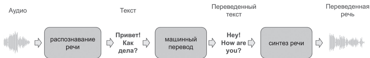
Рис. 1. Схема каскадной системы перевода речи: последовательное применение модулей распознавания речи, перевода текста и синтеза речи
