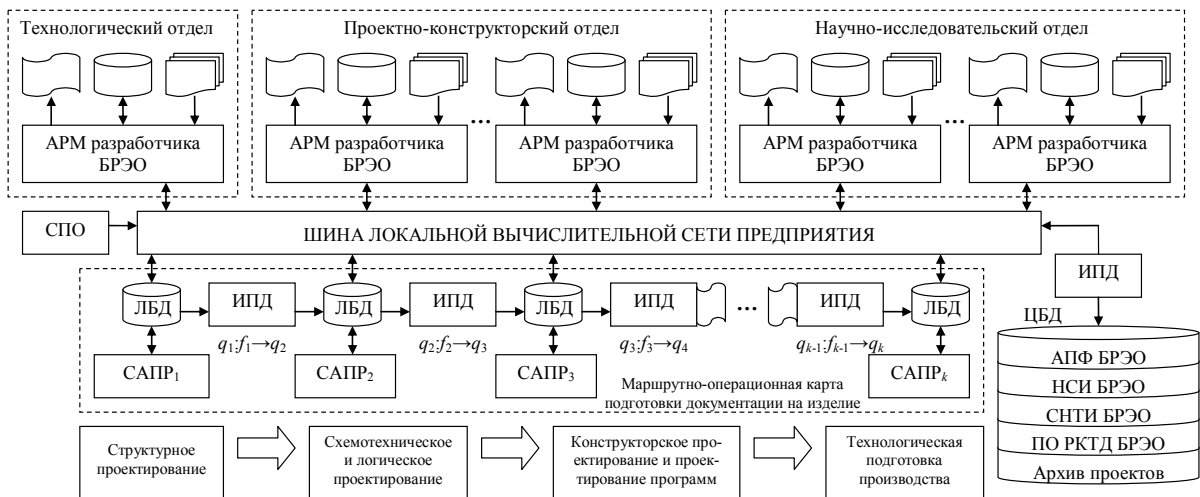
Рис. 5. Схема организации процесса сквозного проектирования изделий БРЭО на базе локальной вычислительной сети предприятия и центрального банка данных проектов предприятия
