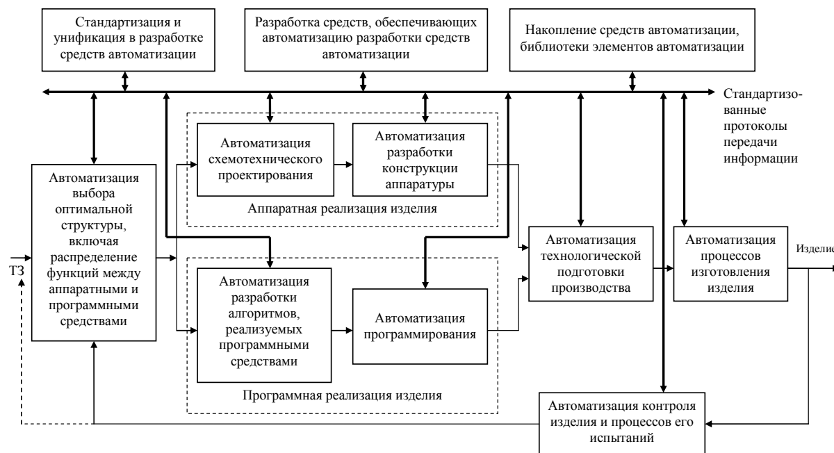
Рис. 3. Схема взаимодействия основных функциональных компонентов, автоматизирующих проектные процедуры создания аппаратуры комплексов БРЭО
