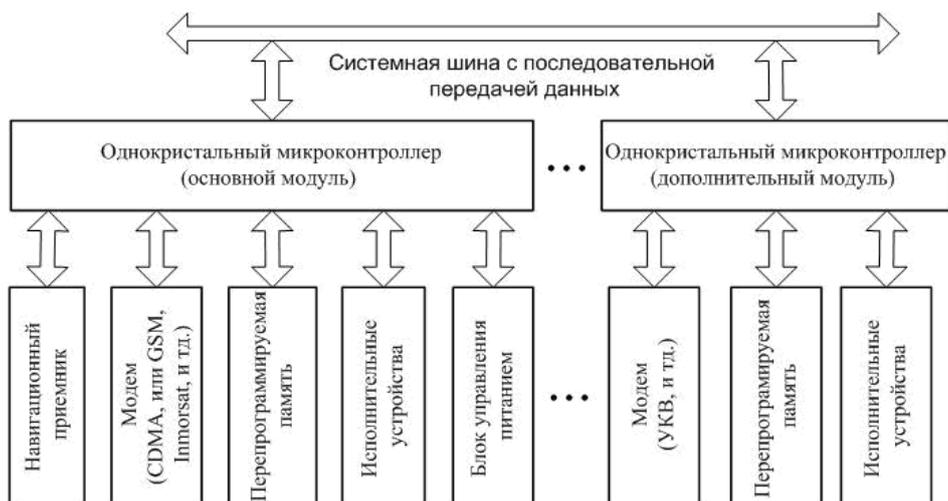
Рис. 1. Структурная схема разработанного мобильного терминала
