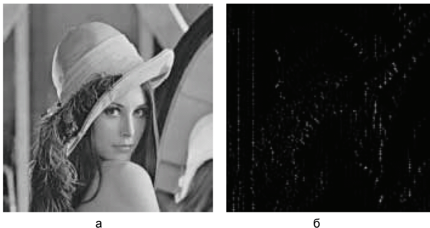
Рис. 4. Маркированное (а) и разностное (б) изображения с параметрами маркирования: a = 0,2 ; L = 2 ; N = 5380
