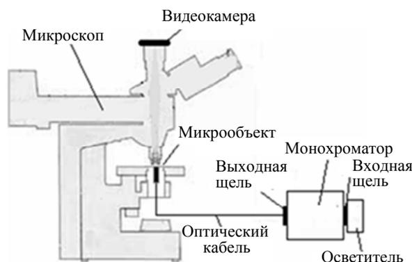
Рис. 2. Блок-схема экспериментального образца микроскопа-гиперспектрофотометра
