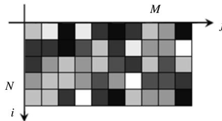
Рис. 1. Дискретная двумерная модель В-скана
