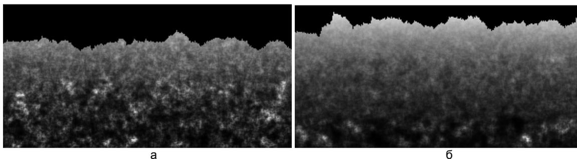
Рис. 6. Смоделированные В-сканы для двухслойной (а) и трехслойной (б) случайно-неоднородных сред со слабо выраженными случайными границами между слоями (размер 300×150 пикселей)
