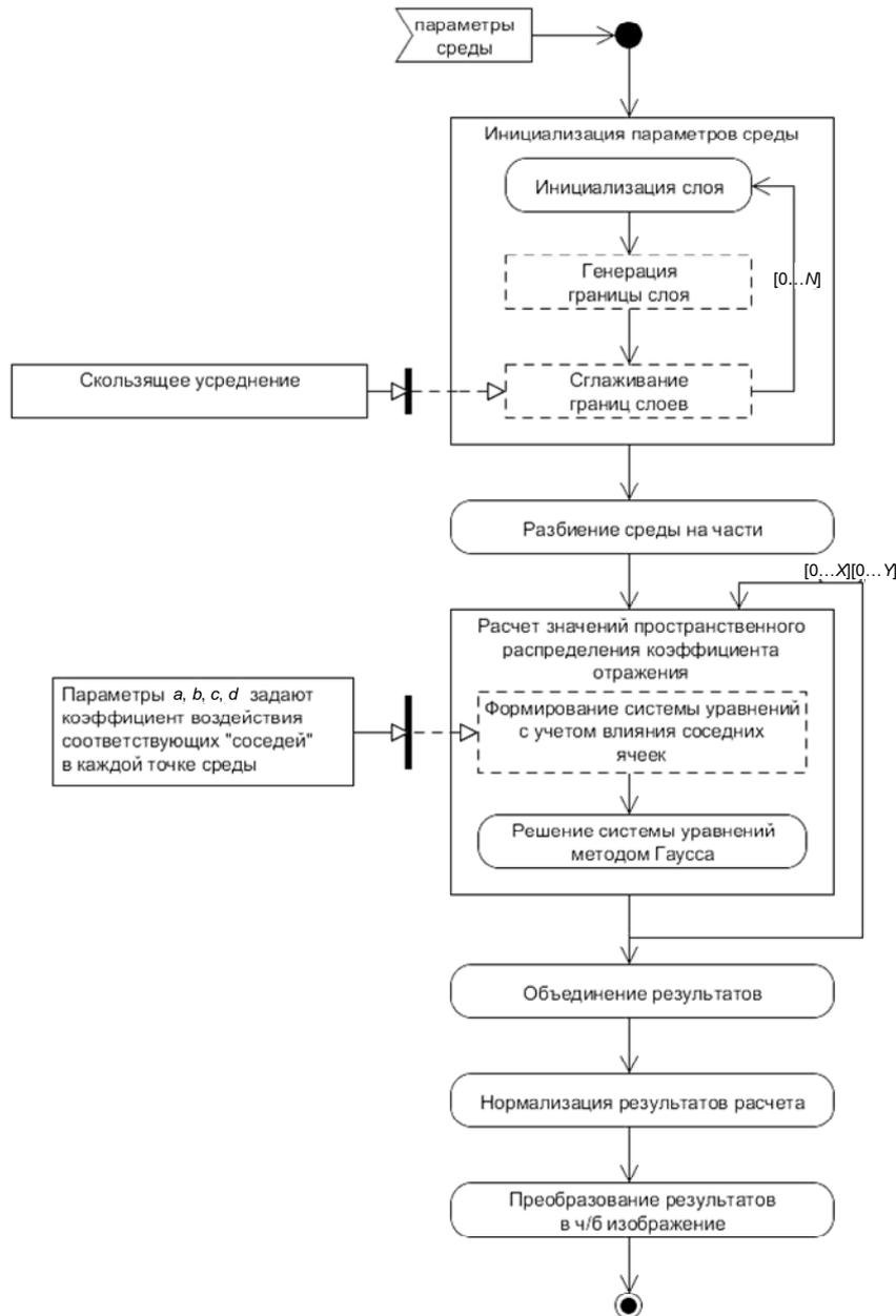
Рис. 5. Блок-схема представления многослойной случайно-неоднородной среды со случайными границами
