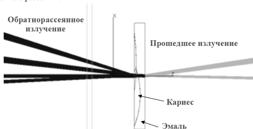
Рис. 10. ТГц отражение образца эмали зуба с кариозными областями
