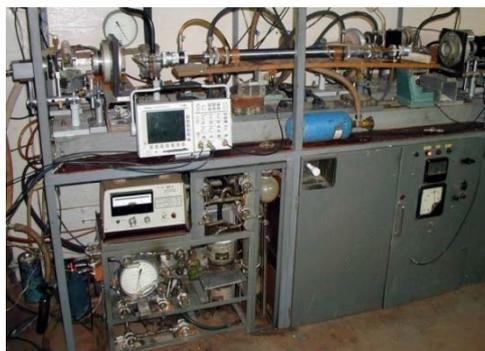
Рис. 17. Экспериментальный стенд с фуллерен-кислород-йодным лазером с накачкой имитатором солнечного излучения
