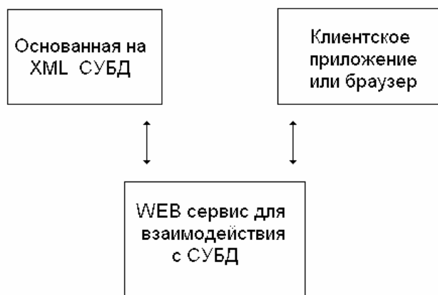
Рис. 2. Схема организации системы электронного архива
