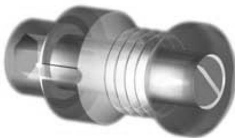
Рис.1. Трехмерная модель, полученная в системе AutoCAD вращением
